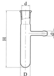
Пример обозначения: ПРОБИРКА С ОТВОДОМ 18-100
