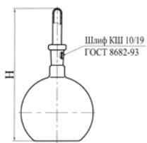
Пример обозначения: ПИКНОМЕТР ПТ-100
