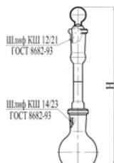
Применяется при определении плотности твердых и сыпучих материалов.
