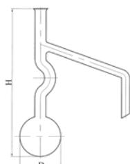
Применяется в аппарате для перегонки парафина под вакуумом при определении температуры начала и конца кипения и установлении процентного выхода дистиллята при заданной температуре по методике ГОСТ 10120.
