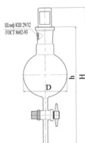
Пример обозначения: ВОРОНКА ДЕЛИТЕЛЬНАЯ ШАРООБРАЗНАЯ
