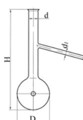
Применяется при проведении работ, связанных с перегонкой нефти и нефтепродуктов..
