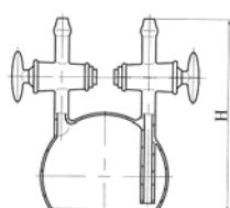
Применяется при определении плотности газов.
